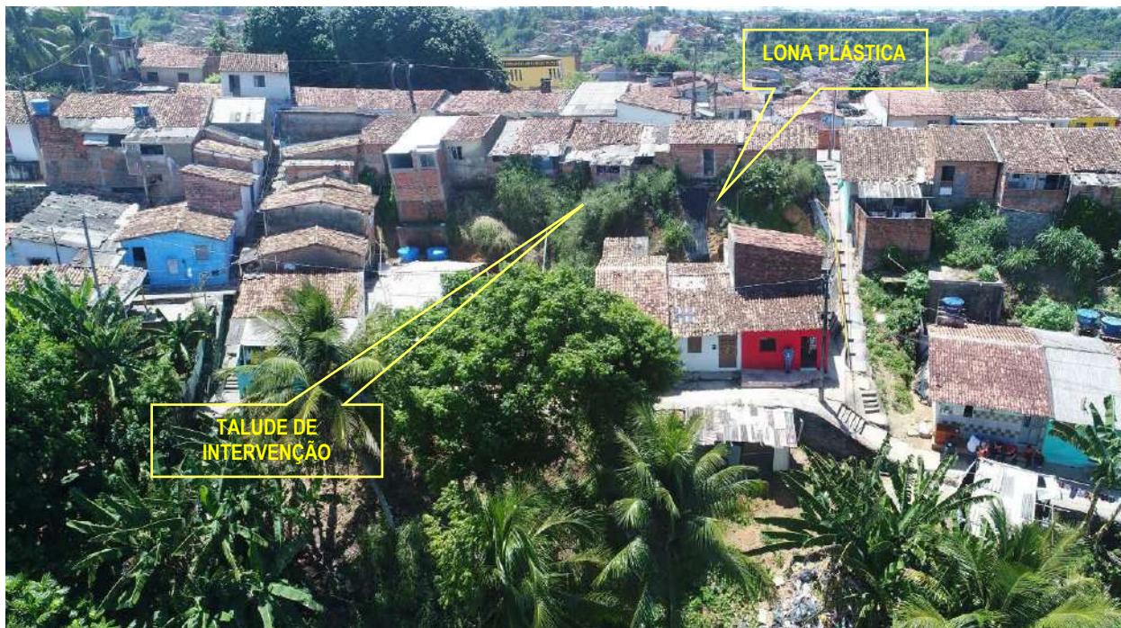
Figura 5.1.- Vista aérea do talude a ser estabilizado, no canto superior direito observa-se a presença de uma lona plástica, com o objetivo de minimizar a ação das águas pluviais.
