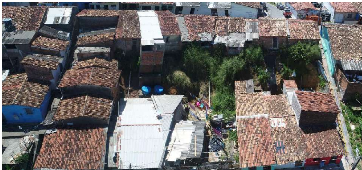
Figura 5.2.- Vista aérea do talude a ser estabilizado, observar fileira de edificações implantadas na crista do talude e que se encontram em risco.
